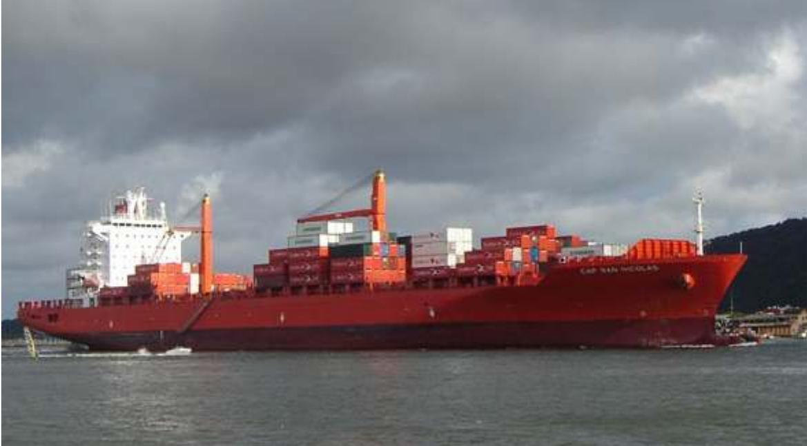
**Figura 10.- Portacontenedores "CAP SAN NICOLÁS" de la naviera Hamburg Süd; un buque que con sus 332 m de Eslora, 48,2 m de Manga, 14 m (46') de Calado y capacidad para 9.600 TEU's excede por mucho y notablemente las capacidades de los canales de aproximación, radas de espera, antepuerto e instalaciones portuarias de Buenos Aires. Por ese motivo no puede entrar a puerto a Plena Carga.**
