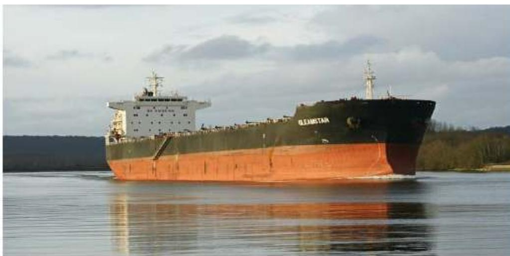
*Figura 3.- Granelero "GLEAMSTAR" navegando en el río Paraná- margen de seguridad debajo de su quilla- de modo que su cargamento sería de unas 40.583 toneladas por lo que le faltaban unas 17.917 para estar completo*
