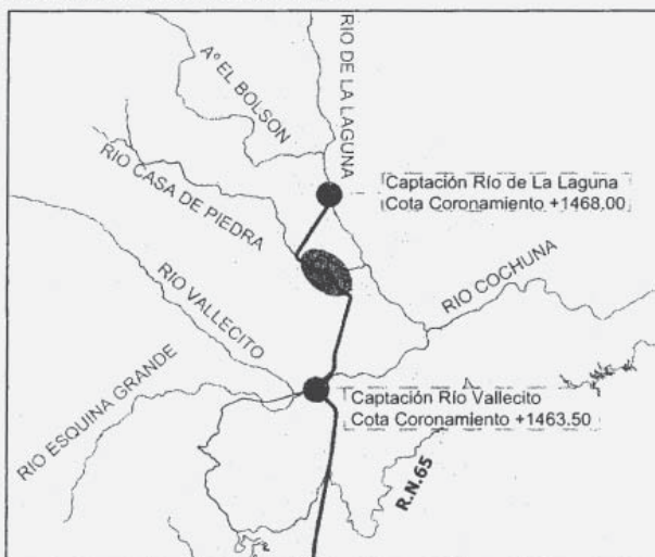
Ilustración 5 – Obras de Captación en la Cuenca del Río Cochuina
