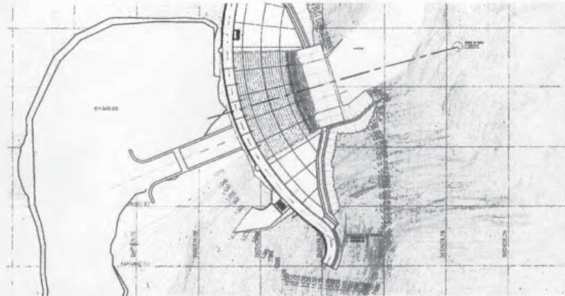
Ilustración 21 – Etapa 4 de Desvío del Río – Remoción de Ataguías y Canal de Desvío Aguas Abajo. Obra Terminada Inicio de Llenado
