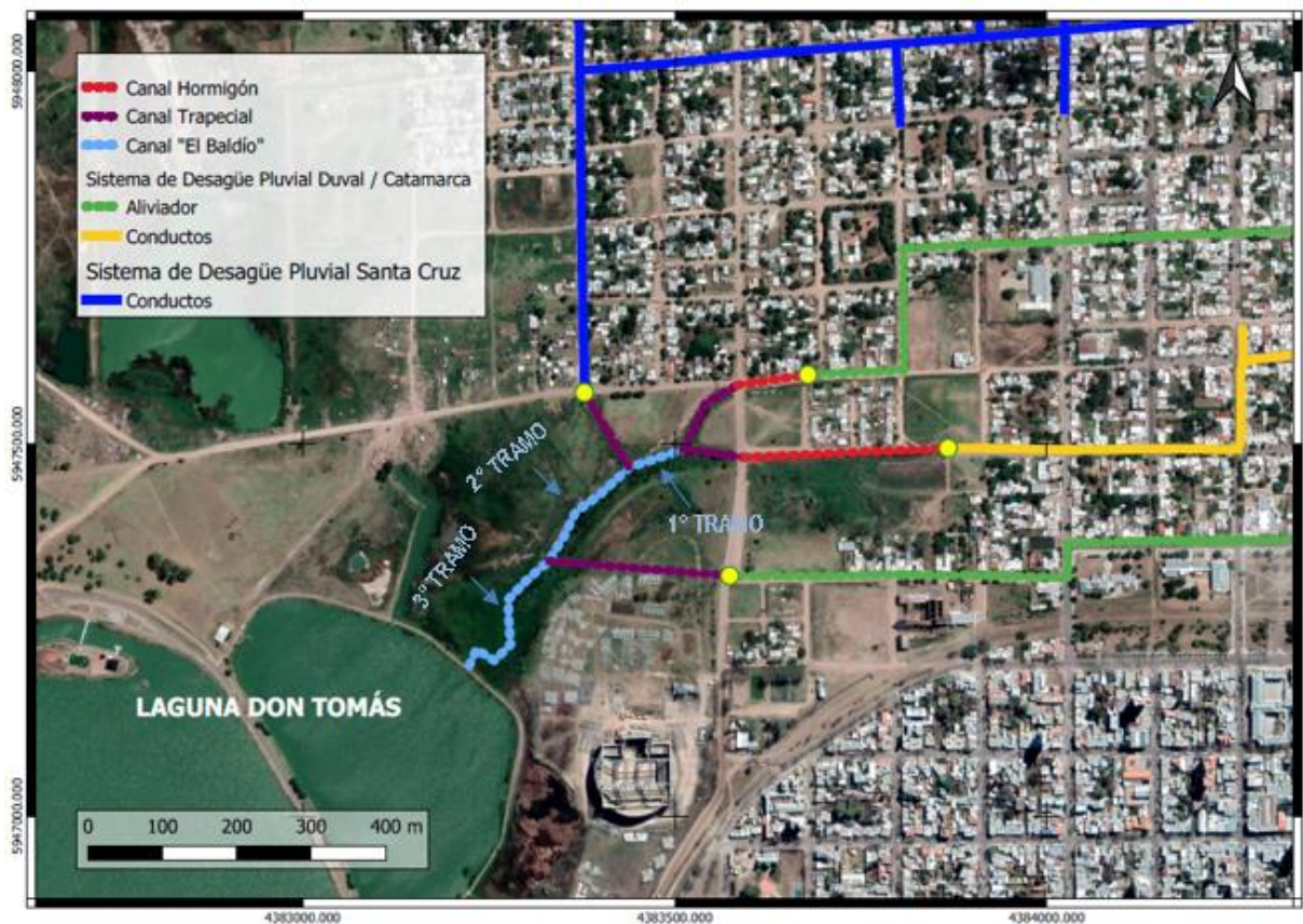
Figura 7 – Punto de vuelco para Sistema de Desagüe Pluvial Santa Cruz
