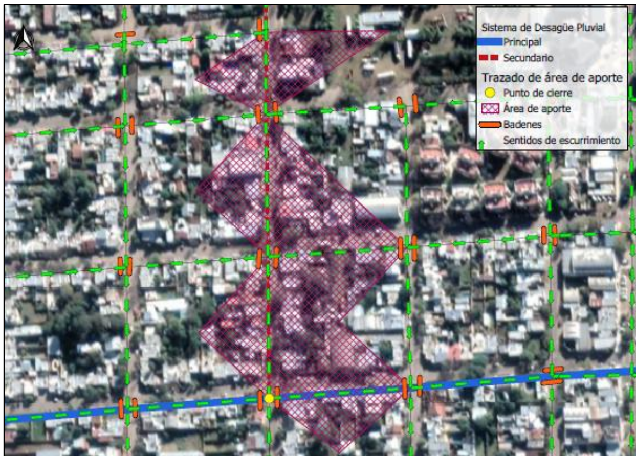
Figura 4.1 – Esquema de Área de Aporte Tipo Trazada para el Predimensionamiento de los Conductos Pluviales
