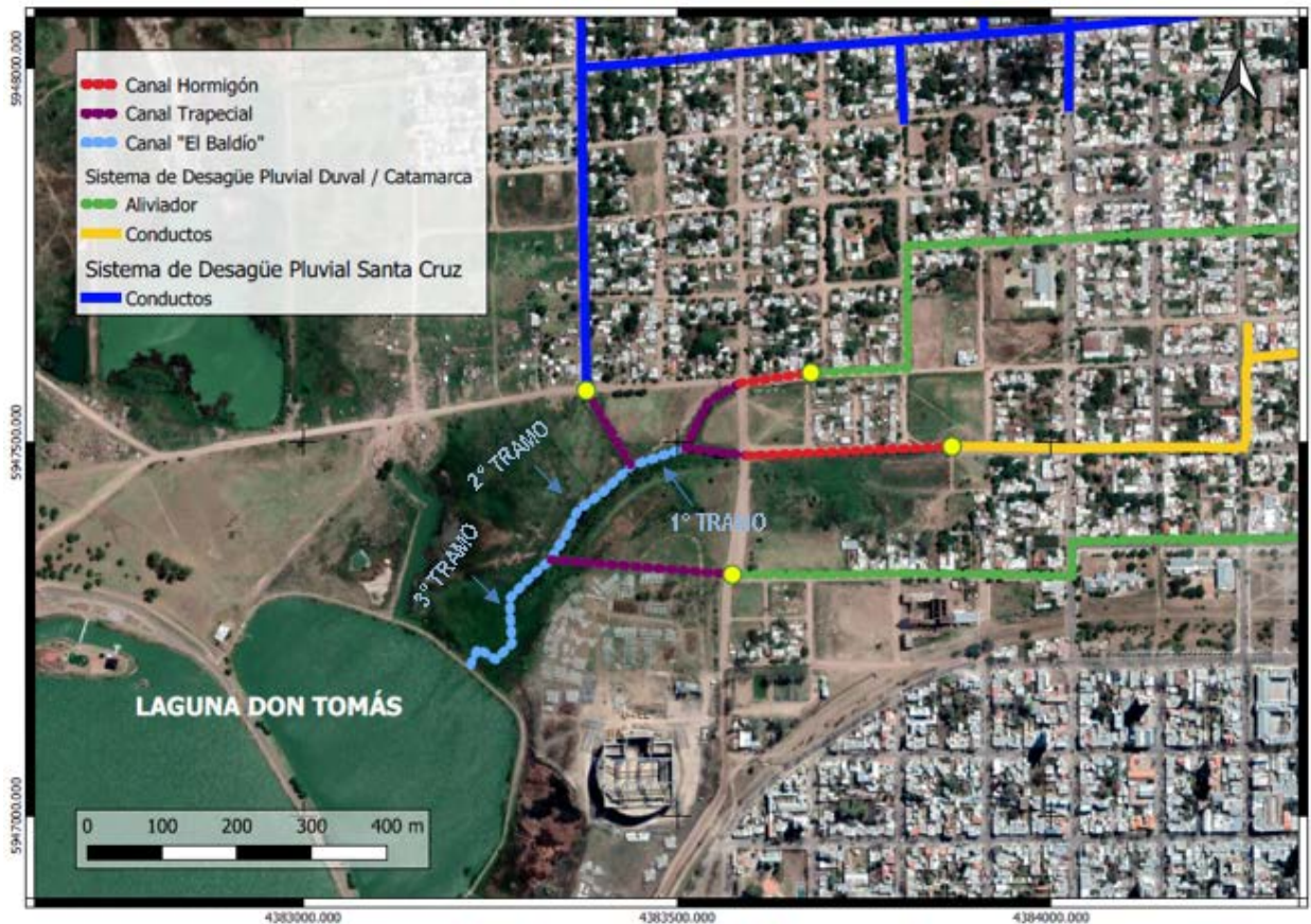
Figura 4 – Punto de vuelco para Sistema de Desagüe Pluvial Santa Cruz
